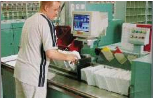
Een invoeroperator bij de Sorteermachine Klein
