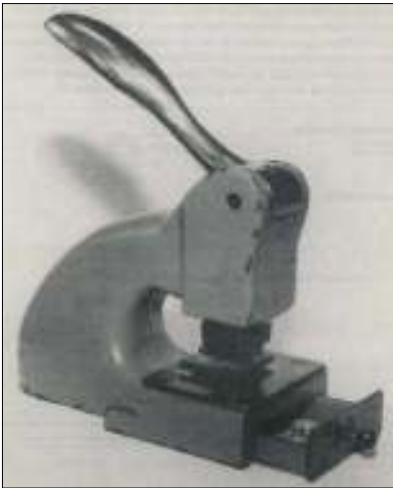
Afb. 9: De perforator van PNEM 2 was ongeveer 15 cm. hoog. Hij woog 2 kilo. Een laatje ving de uitgeponste gaatjes op.
