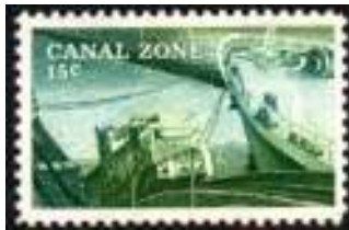
Afb. 20: locomotief trekt met kabels schip in sluis
